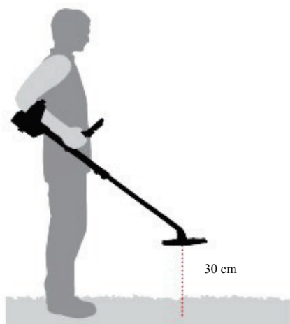
Obrázek 17 – Správná poloha držení detektoru během probíhající funkce odhlučnění.
